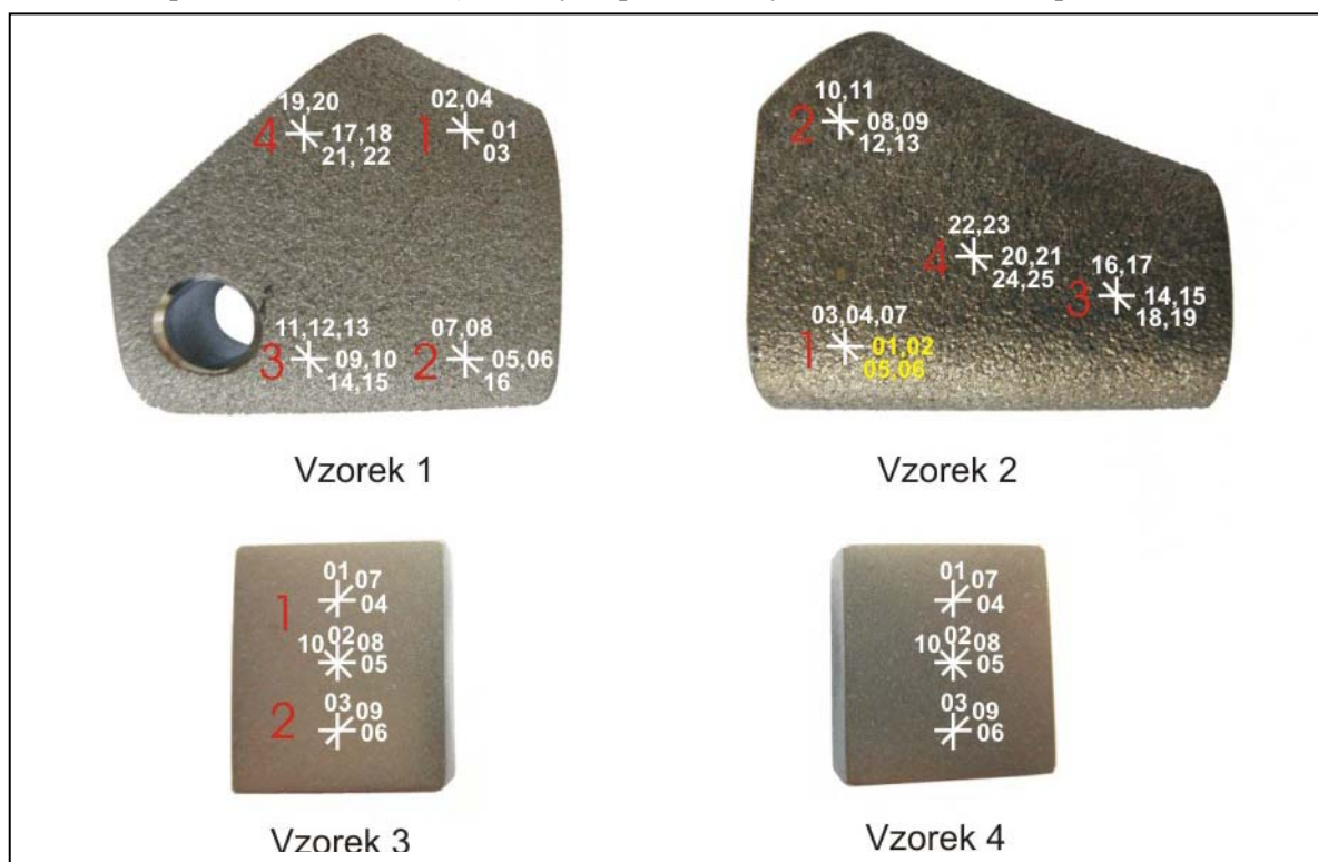
Obrázek 1: Znárodnění míst, kde byly vzorky proměřeny: vzorek 1 – plazmový nástřik, vzorek 2 – jiskřený vzorek, vzorek 3 – tryskaný 1, vzorek 4 – tryskaný 2.
